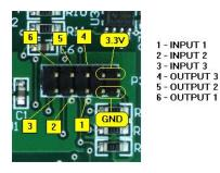
Inputs MAX 3.3V, 20mA Outputs 3.3V, 20mA
